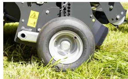
Pneumatici affidabili per un elevato controllo del pick-up e semplice regolazione dell'altezza.
