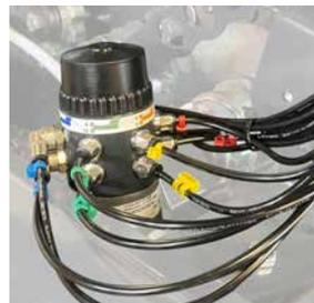
Lubrificazione automatica delle catene con uscite regolabili individualmente.
