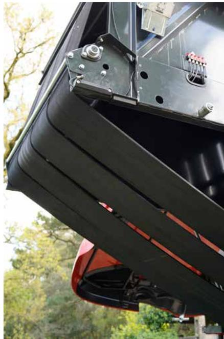
I modelli BV6160 e BV6190 sono dotati di quattro cinghie senza fine di lunga durata che garantiscono un funzionamento regolare e una manutenzione ridotta.
