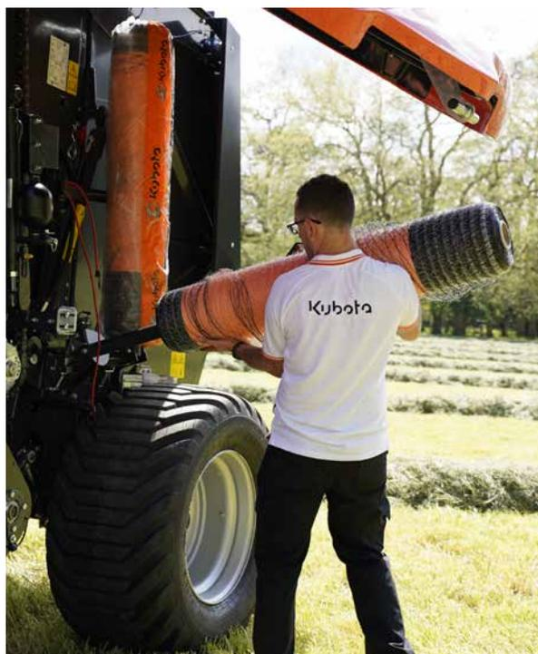
L'intelligente sistema di stoccaggio delle bobine di rete consente un comodo caricamento orizzontale.
