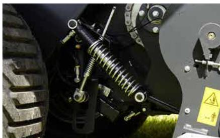
Martinetto idraulico per l'alzamento del pick-up con sistema di sospensione integrato per un accurato seguimento del profilo del terreno.
