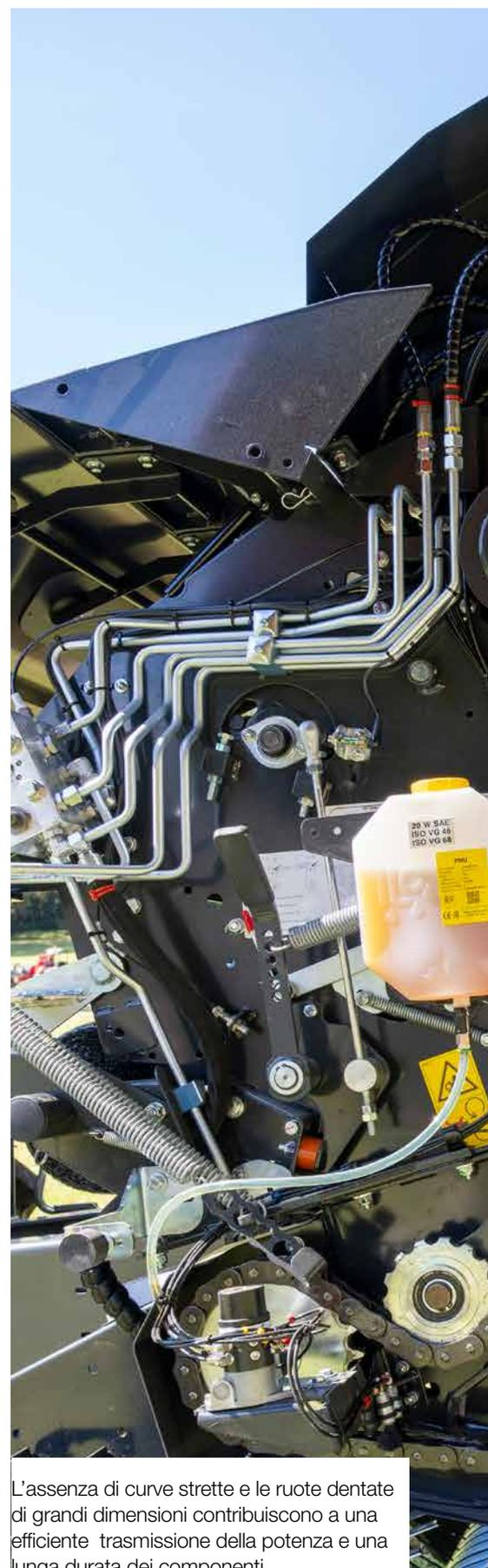
L'assenza di curve strette e le ruote dentate di grandi dimensioni contribuiscono a una efficiente trasmissione della potenza e una lunga durata dei componenti.
