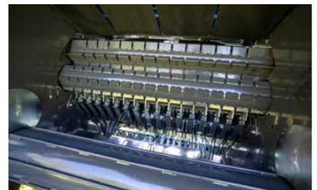
I rulli profilati garantiscono la formazione istantanea delle balle e sono dotati di raschiatori autopulenti progettati per lavorare in tutte le condizioni colturali.
